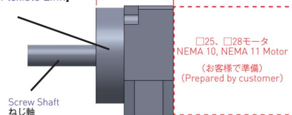
参考例：ボールねじ軸径φ6mm、□28モータの一般的なカップリング連結と比較した場合。
